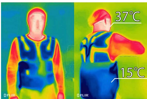
圧倒的な冷却力をサーモグラフィーで見て取れます。
